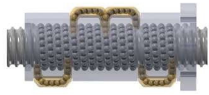
Laufbahn-Darstellung der Teilkugel der Normal- und Hochgeschwindigkeits-Serie FEKS der Hochleistungs-Kugelumlaufspindel FEKS series high-speed type steel ball with retainer circulation trajectory diagram
