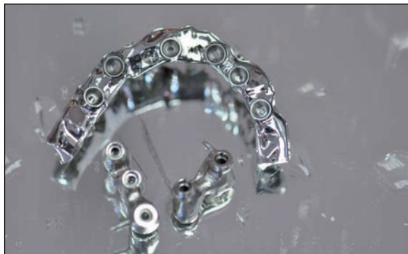
FIG. 7 / Vue des armatures usinées en titane d'après la conception 3D précédemment tracée par le logiciel.
