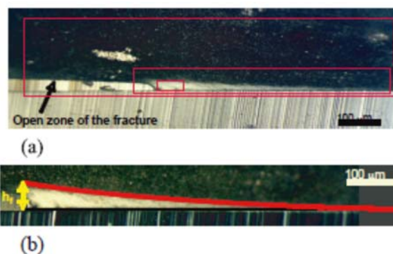
Figure 33: Déformation plastique lors du décollage d'un ruban adhésif. Figure fournie par L. Léger.
